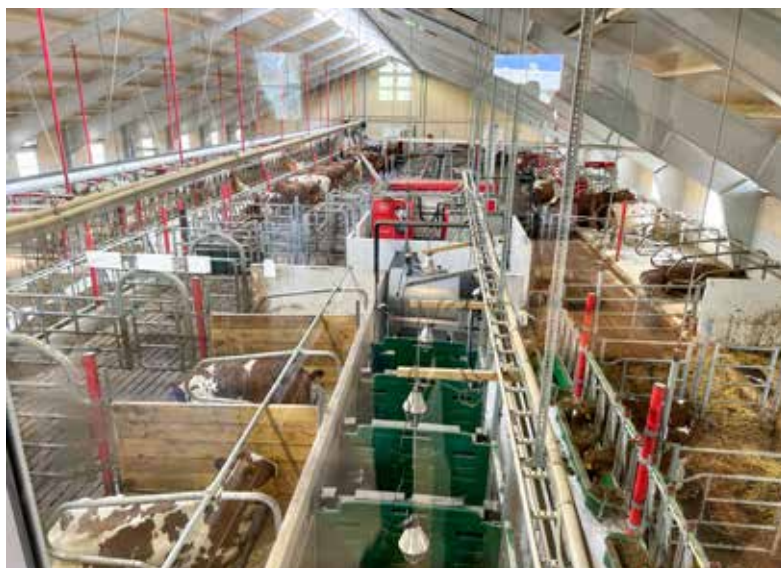
Fire rekker med liggebåser på melkekusiden av førbrettet. Ammeku og ungdyr på andrte siden. Velferdsavdeling bak melkeroboten pluss 4 kalvingsbinger og binger til inseminasjon.
