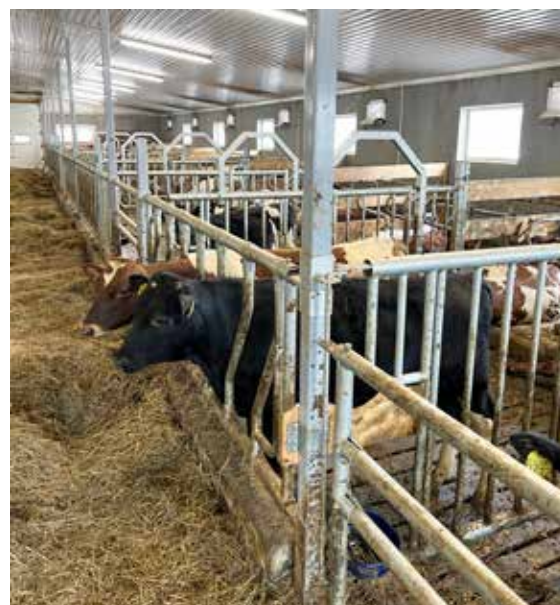
Små binger med plass til fire dyr i hver for å unngå stort språk i alder og størrelse. Legg også merke til plassering av lysarmatur på tvers av fjøsretning for ikke å hindre optimal luftsirkulasjon.
